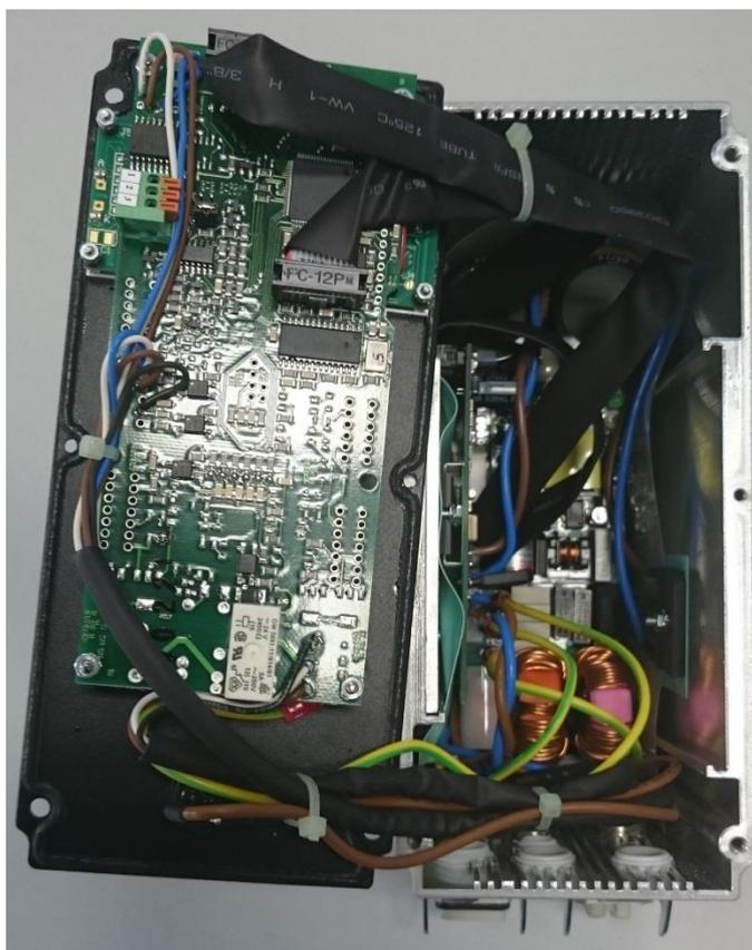
Lors de la fermeture du couvercle du boîtier, veiller à ne coincer aucune conduite.
