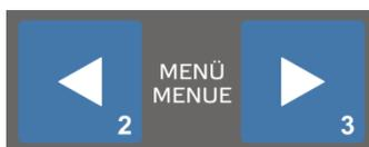
L'activation simultanée des touches 2 et 3 permet d'accéder directement à l'écran de démarrage avec l'amplitude d'oscillation (vitesse d'acheminement).
