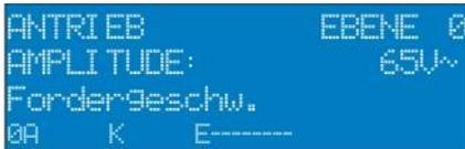
À l'écran, un « K » (pour « Keylock », verrouillage du clavier) apparaît à la dernière ligne.
