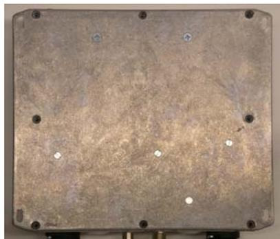
Koppla apparaten spänningsfri. Demontera FC 1000 genom att lossa de fyra fästskruvarna (se kapitel 3.1).
