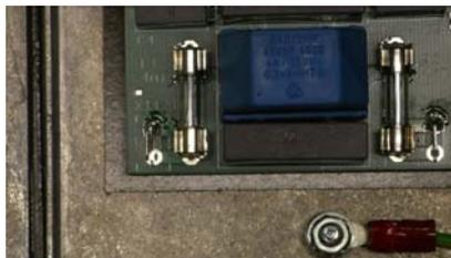
Lägg apparaten (ännu oöppnad) på baksidan och öppna sen kapslingens lock. Nu kan ni byta ut de defekta säkringarna mot nya.
