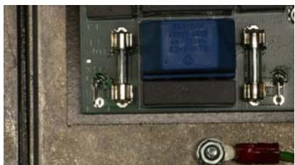
Volte a colocar o aparelho (ainda por abrir) sobre a parte traseira e retire a tampa da caixa. Agora pode substituir os fusíveis avariados por novos. (micro fusível 4x20 mm 4AT)
