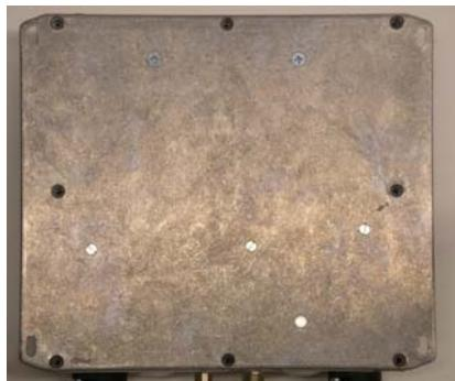
Desligue a tensão no aparelho. Desmonte o FC1000 desapertando os quatro parafusos de fixação (ver capítulo 3.1).
