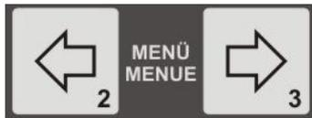
Durch gleichzeitiges Drücken der Tasten 2 und 3 wird direkt zum Display - Startbild mit der Schwingamplitude (Fördergeschwindigkeit) navigiert.
