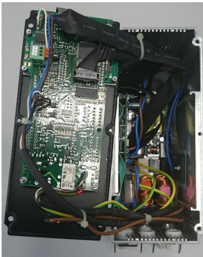
Achten Sie beim Schließen des Gehäusedeckels darauf, dass keine Leitungen eingequetscht werden.
