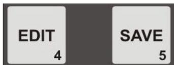
Durch gleichzeitiges Drücken der Tasten 4 und 5 wird im Display die Version der Firmware angezeigt.
